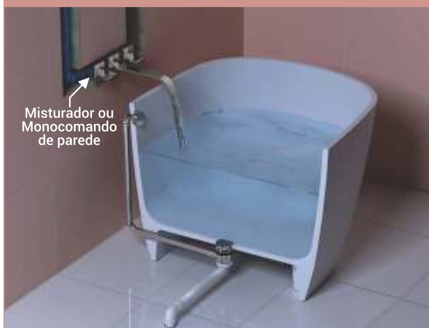
Opção 3: Misturador ou monocomando instalado na parede
