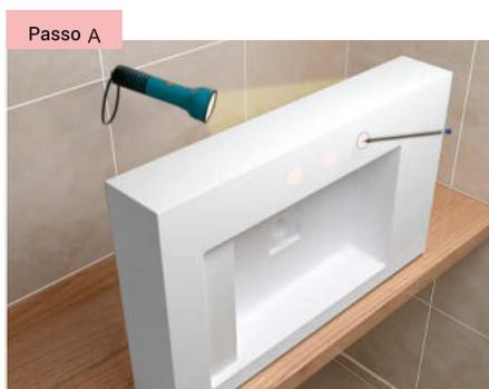
Iluminar com uma luz forte (lanterna do celular) por debaixo da cuba, o contorno do furo será visível. Marcar com uma caneta o centro do furo, na parte superior da cuba.
